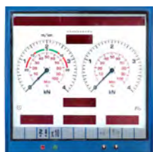
Dubbele analoge uitlezing IW 4 of IW 7, met 2 of 4 wijzers.
