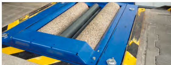
Speciale aangepaste lage rollenstellen voor mobiele remmentesten.
