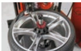
Demontage van de bovenste bandhiel.
