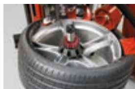
Montage du talon du pneu supérieur.
