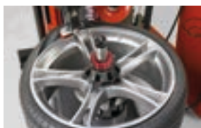
Démontage du talon du pneu supérieur.
