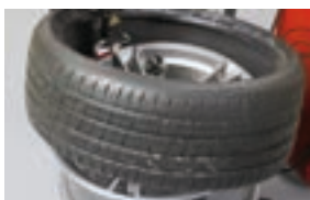
Montage du talon du pneu inférieur.
