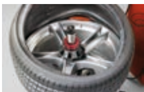
Démontage du talon du pneu inférieur.
